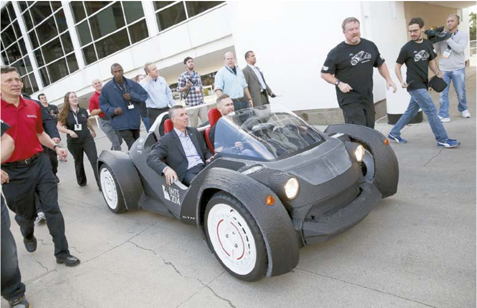
LOCAL MOTORS OPRACOWAŁ AUTO, KTÓREGO NADWOZIE MOŻNA WYDRUKOWAĆ NA DRAKARCE 3D. POJAZD TEN JEST WYKONANY Z WŁÓKNA WĘGLOWEGO WZMOCNIONEGO TWORZYWEM ABS I JEST W PEŁNI SPRAWNY. ELEMENTY MECHANICZNE POCHODZĄ Z MODELU RENAULT TWIZY, NAPĘD JEST ELEKTRYCZNY/FOT.: FAVABLE.COM
